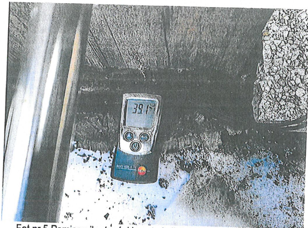
Fot nr 5 Pomiar wilgotności konstrukcji drewnianej przy podporze.
